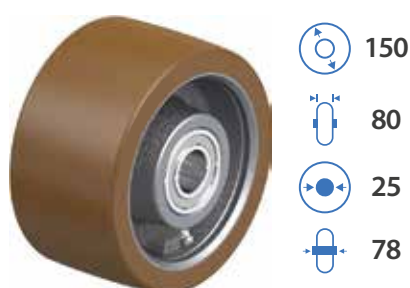
Опорное колесо 150-80-25-78
