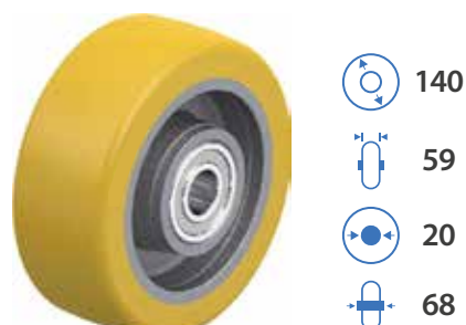
Опорное колесо 140-59-20-68
