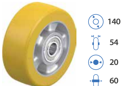
Опорное колесо 140-54-20-60
